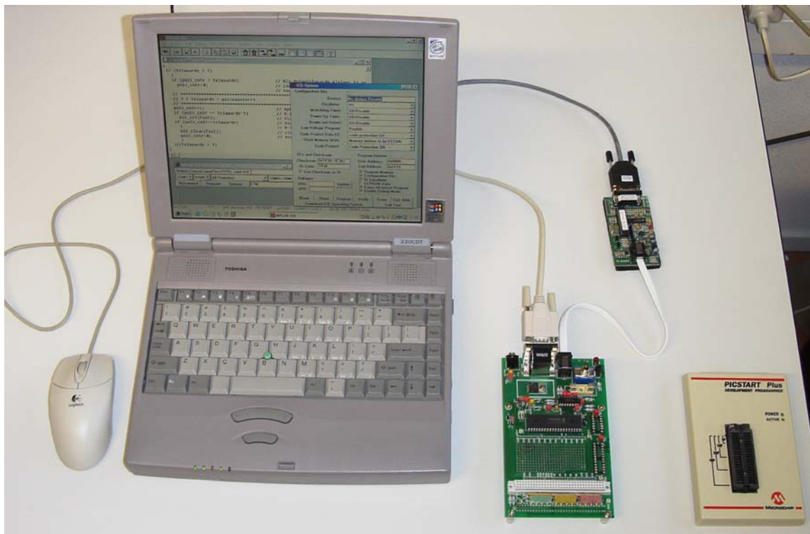
fig. 4. Ontwikkelomgeving met Picprocessorprint en ICD
